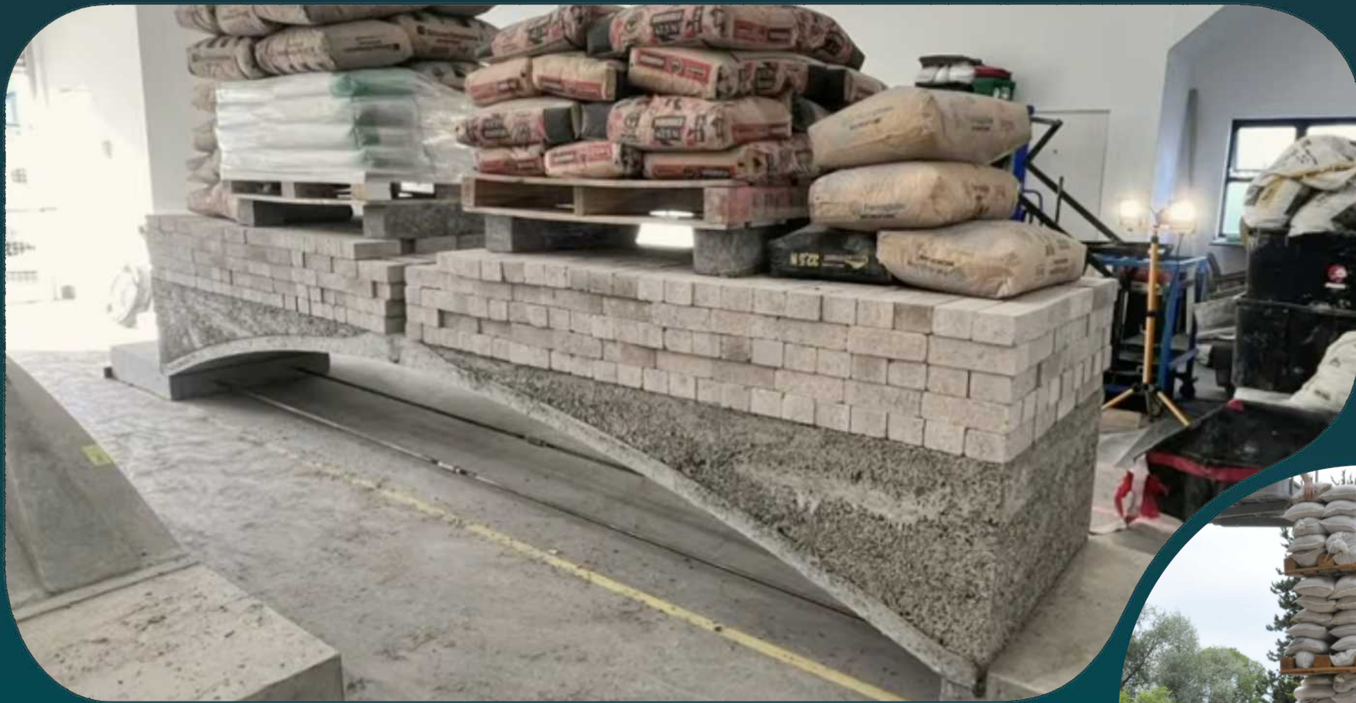
Кровельные оболочки которые работают на сжатие, без арматуры ( от Philip Block Research Group ETH Zurich )
